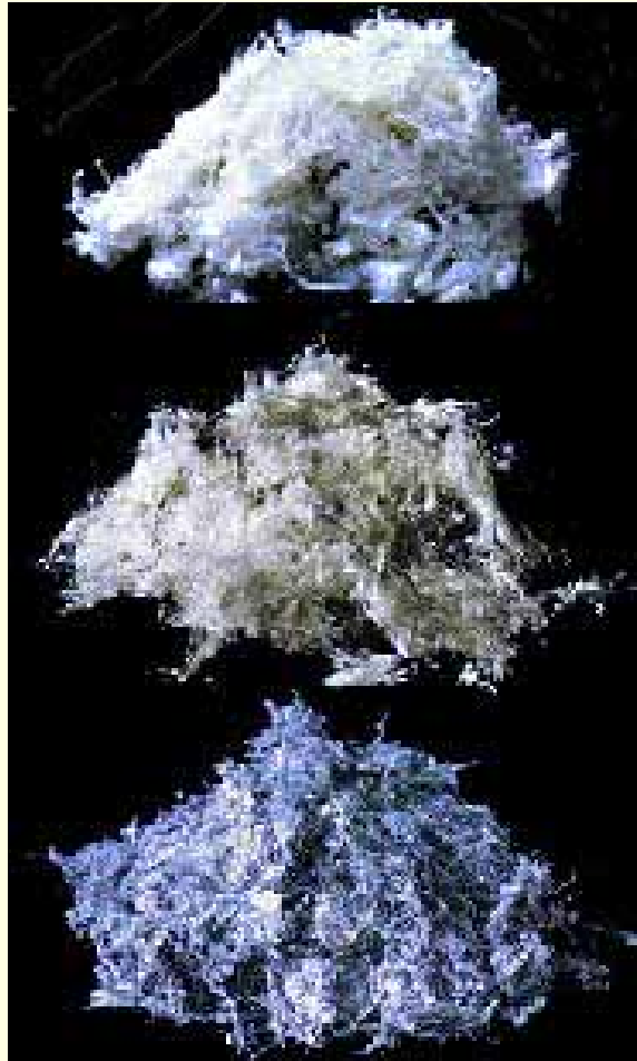
Amiante blanc (chrysotile)
