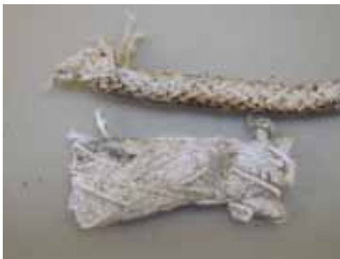
Corde in amianto per l'isolamento di punti facilmente infiammabili
