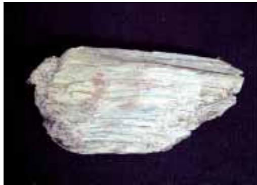
Amiante blanc (chrysotile)
